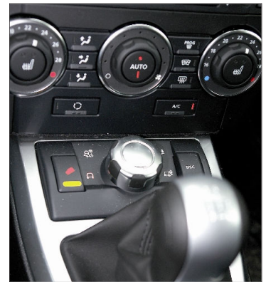
Terrain Response®: Durch Drehen am Wahlschalter werden Motor, Schaltung, Fahrwerk und Traktionseinstellungen auf optimale Fahreigenschaften unter den verschiedensten Bedingungen eingestellt.
